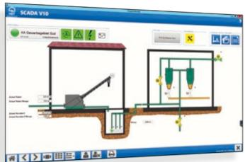
Die konsequente Branchenausrichtung in Zusammenarbeit mit Betreibern hat SCADA V10 zur maßgeschneiderten Lösung für die Wasserwirtschaft gemacht. Mit Standardtechnologien ist SCADA V10 systemoffen und perfekt mit anderen Applikationen vernetzbar. Die Integration von TeleCam-Video-Systemen ermöglicht die simultane Analyse von Ganglinien und Kamerabildern. Einzigartig zur Prozessanalyse!
