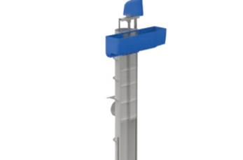
HydroKlar-SLIDE Klarwasserabzüge sind sowohl in der Wasserversorgung als auch in Abwasserreinigungsanlagen vielfältig einsetzbar. Die spezielle Abzugsvorrichtung mittels Klaviertasten-Wehr ermöglicht den Abzug großer Wassermengen auch bei kleiner und kompakter Baugröße. Die Ablaufmengen lassen sich so flexibel prozessorientiert einstellen.
